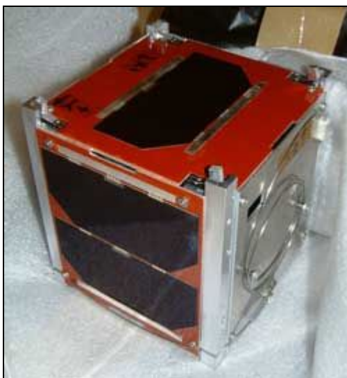
Figura 1 – Foto de um CubeSat. 1
