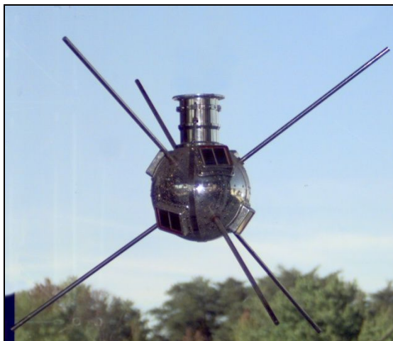
Figura 8 – Vanguard 1, primeiro satélite a utilizar células fotovoltaicas 8 .
